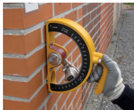
Fig. 1 Mesure de la dureté à l'aide d'un scléromètre
