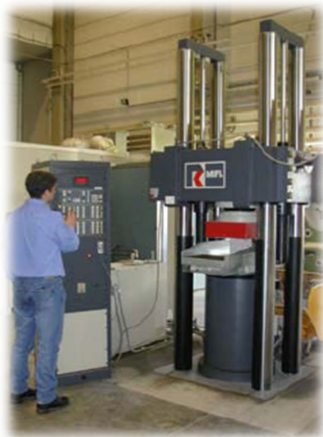
Figuur 36. Bepaling van de druksterkte van metselwerk.
