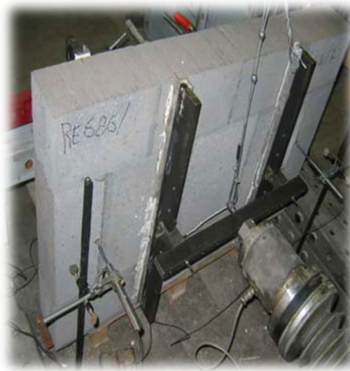
Figuur 40. Bepaling van de loodrechte buigsterkte( f_{xk2} ).
