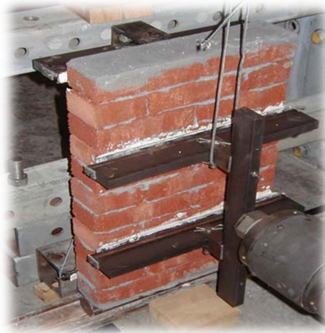
Figuur 39. Bepaling van de parallelle buigsterkte ( f_{xk1} ).
