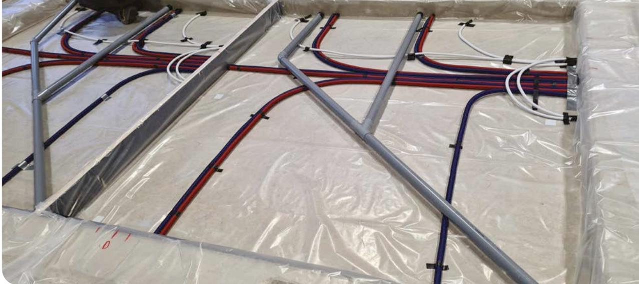
**2** Deux dispositifs d'essai avec des réseaux de conduites identiques, avant application de la couche de nivellement.
