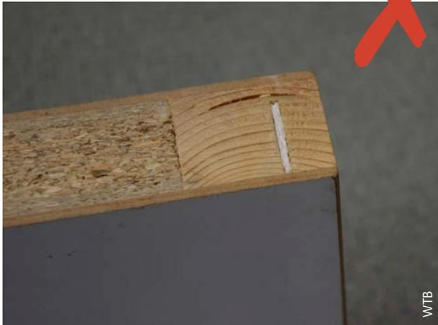
1 | Das Querholz des Türblatts und das schaumbildende Produkt wurden vollständig abgehobelt.
