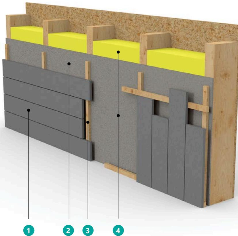
2 | Das vollständige System muss für das Bewerten der Brandverhaltensklasse der Fassadenverkleidung berücksichtigt werden.
