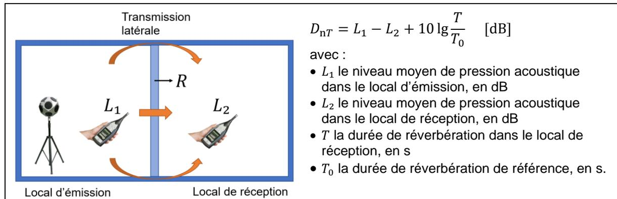
**Fig. 2 Détermination *in situ* de l'isolement acoustique standardisé  $D_{nT}$  entre deux locaux selon la norme NBN EN ISO 16283-1.**
