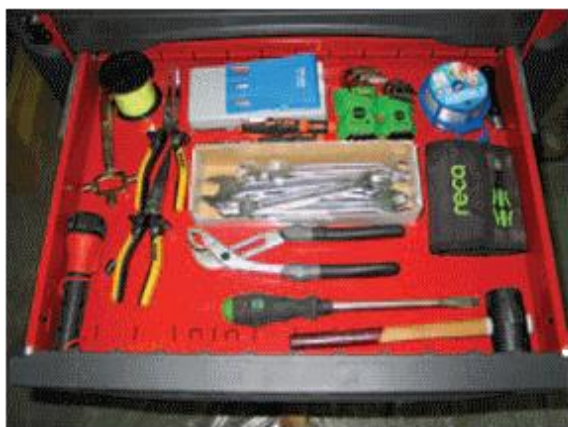
Figure 4 Les sets d'outils A1 et A2 pour l'essai manuel sur des éléments de la classe de résistance à l'effraction RC2.
