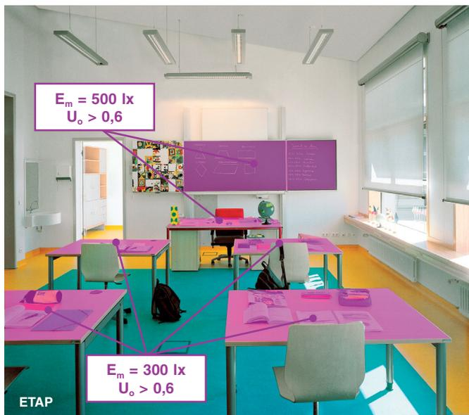
Grundbeleuchtung und Einförmigkeit in einem Klassenraum.
