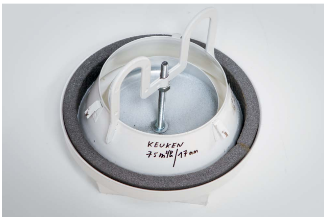
Afb: Geblokkeerd en gemarkeerd ventiel (naam van de ruimte, ontwerpdebiet en afstelpositie)
