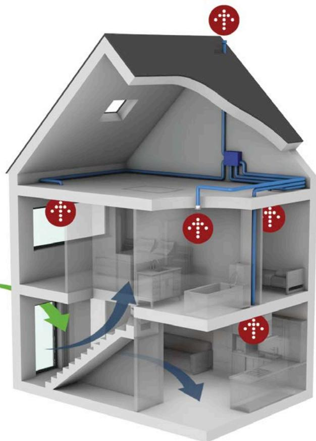
2 | Illustration der auf einem System C basierten Variante, mit natürlicher Zufuhr über die Eingangsdielen.
