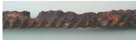
Korrosion eines Armierungsstabes.
