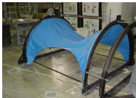
Abb. 3 Ausführung einer doppelgekrümmten Schalstruktur mit Spritzbeton.
