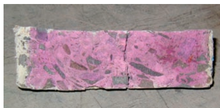
Bestimmung der Karbonisierungstiefe an einem Betonprobekern.
