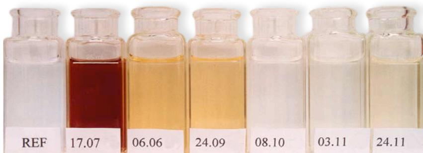
3 | Verfärbung des Wassers, das von einem Flachdach mit einer Dichtungsmembran stammt.
