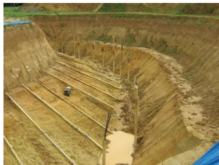
Prüfungen von Erdankern im natürlichen Maßstab.
