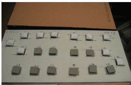
Haftfestigkeitsprüfungen an einem Putzsystem, das auf einem Dämmstoff angebracht ist.
