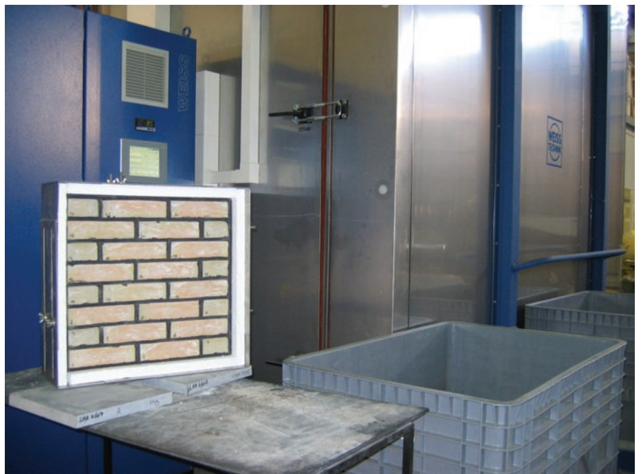
Versuchsstand zur Ermittlung der Frostbeständigkeit eines Fassadenmauerwerkes.
