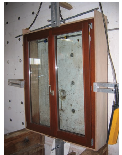
WTB-Versuchsstand zur Ermittlung der Wasser- und Luftdichtheitsleistungen von Schreinerarbeiten.
