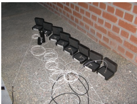
Prüfung zur Ermittlung der flankierenden Schallübertragung.
