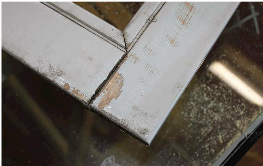
2 | Dégradation des angles à la suite d'un collage non optimal
