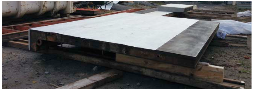
1 | Schalungsplatte, die teilweise mit einem CPF-Liner versehen wurde.
