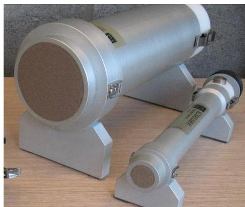
Figure 1 Détermination du coefficient d'absorption acoustique  $\alpha$  sous incidence normale du bruit à l'aide du tube de Kundt selon la norme NBN EN ISO 10534.
