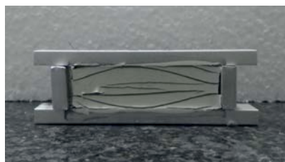
B. Scheurvorming en afschilfering van de verf na trek-drukbelastingen
