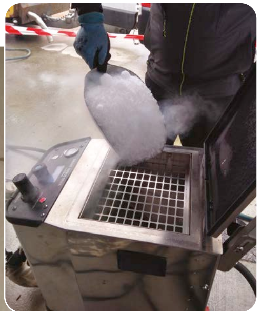
1 Gevelreiniging met droogijsstralen en een kleine toevoeging van klassiek straalmiddel.
