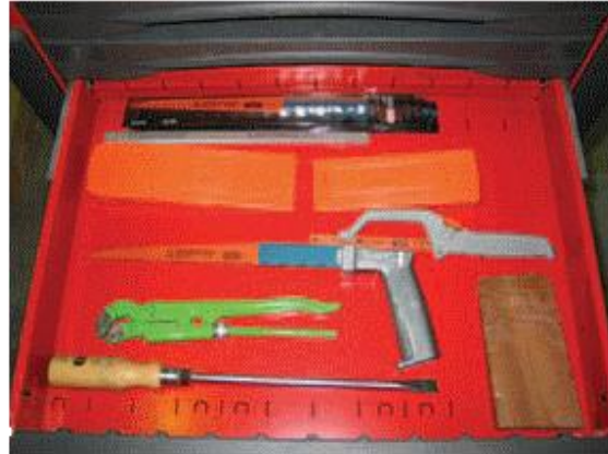
Figuur 5 Gereedschapsets A1 en A2 voor de manuele proef op elementen met inbraakweerstandsklasse RC2.
