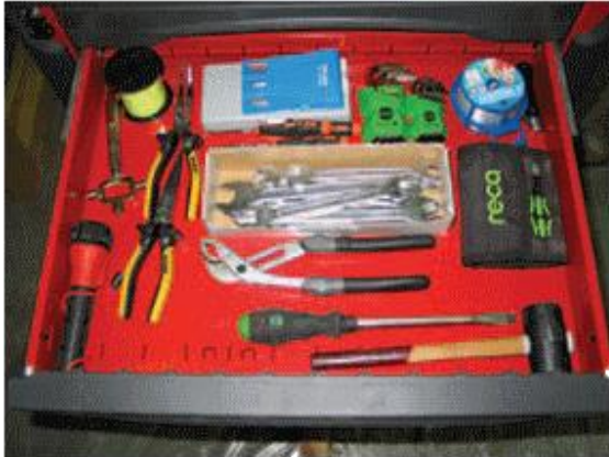
Figuur 5 Gereedschapsets A1 en A2 voor de manuele proef op elementen met inbraakweerstandsklasse RC2.
