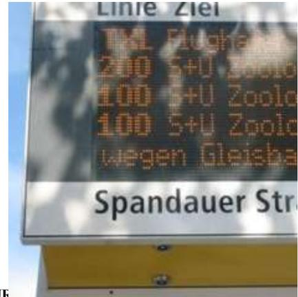
FIGURE 20 : EXEMPLE D'UN JOURNAL LUMINEUX DIFFICILEMENT LISIBLE EN RAISON DE LA LUMIÈRE INCIDENTE
