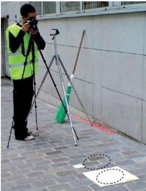
FIGURE 75 : MESURE DU CONTRASTE À L'AIDE D'UN APPAREIL PHOTO
