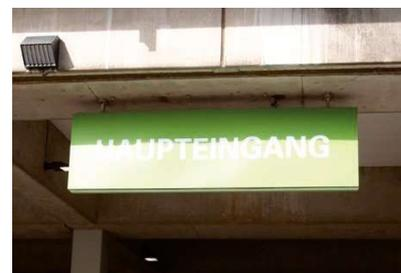
**FIGURE 55 : LA VISIBILITÉ DE LA SIGNALISATION EST RÉDUITE PAR L'ASPECT BRILLANT ET L'OMBRAGE**
