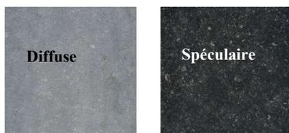
**FIGURE 54 : MÊME RÉSULTAT EN CAS DE MESURE DE LA COULEUR, MAIS ASPECT DIFFÉRENT – GÉOMÉTRIE DE MESURE : D65, 10°, D/8°, SCI**
