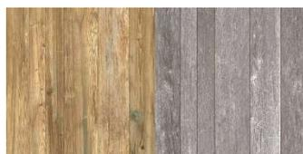
**FIGURE 56 : DÉCOLORATION DE MATÉRIAUX NATURELS DUE À UN GRISONNEMENT OU UNE OXYDATION**
