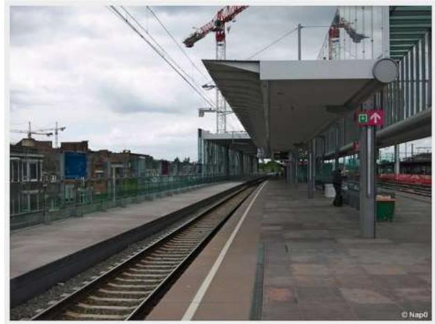
**FIGURE 53 : EXEMPLE DE BANDE CONTRASTANTE DE 10 CM DE LARGEUR PLACÉE À CÔTÉ DES AVERTISSEURS DE VIGILANCE (GARE DE GAND-SAINT-PIERRE)**
