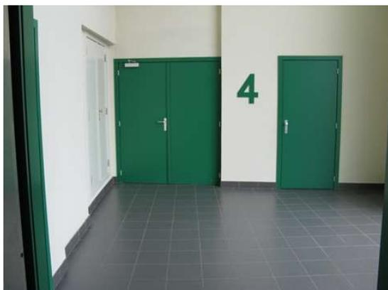
FIGURE 26 : LES PORTES ACCESSIBLES CONTRASTENT, LES AUTRES SONT DE LA MÊME COULEUR QUE LE MUR
