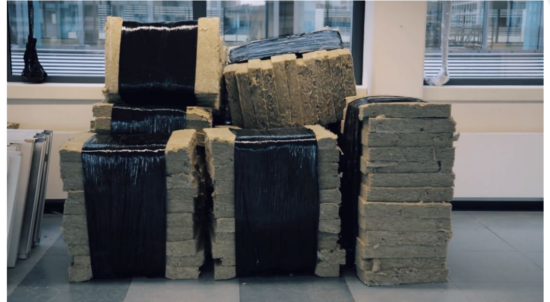
Recuperatie isolatie uit RSZ-gebouwen (WTCB)
