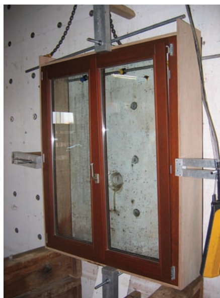
WTCB-proefpost ter bepaling van de lucht- en waterdichtheidsprestaties van schrijnwerkelementen.
