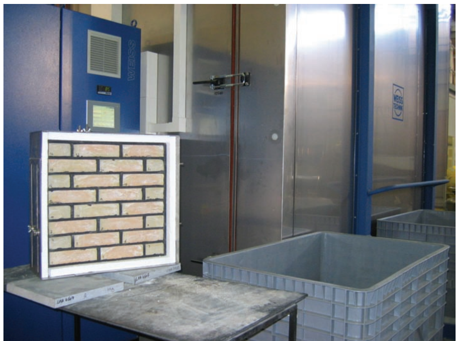
Proefpost ter bepaling van de vorstbestendigheid van gevelmetselwerk.
