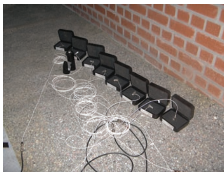
Proef ter bepaling van de flankerende geluidstransmissie.
