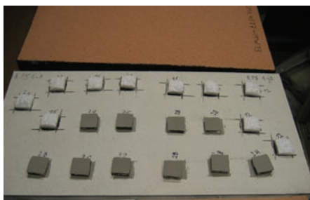
Hechttingsproeven op een op een isolatie aangebrachte bepleistering.
