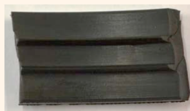
5 | EPDM enduit de détergent (après essai)
