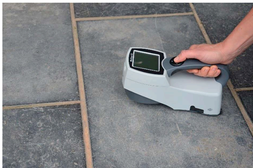
Exécution d'une mesure de teinte
