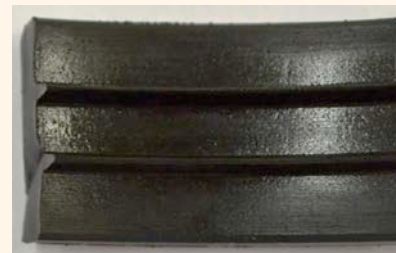
3 | EPDM enduit de silicone (après essai)
