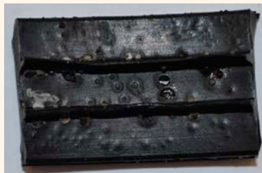
2 | EPDM enduit de graisse (après essai)
