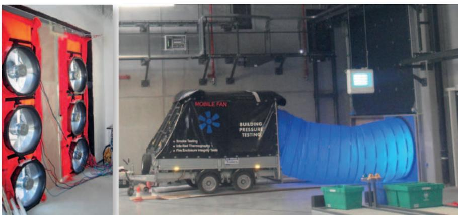
**Fig.1 et 2** A gauche : portes de pressurisation 'multiventilateurs' pour la réalisation d'essais dans des grands bâtiments. A droite : ventilateur adapté aux très grands bâtiments permettant de fournir des débits d'air de l'ordre de 100.000 m³/h.
