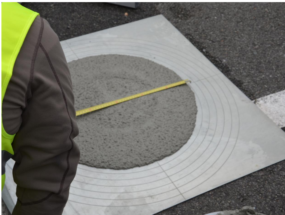
Figure 3 - Mesure de l'étalement au cône Abrams (slump flow)
