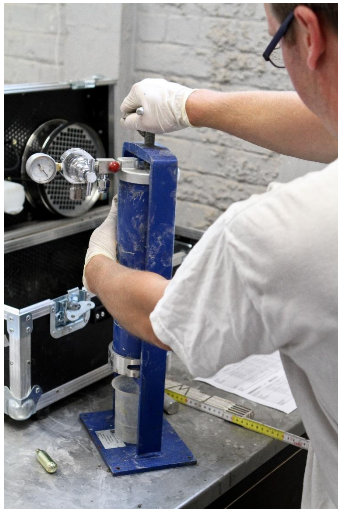
Figure 5 - Mesure du ressuage Bauer test
