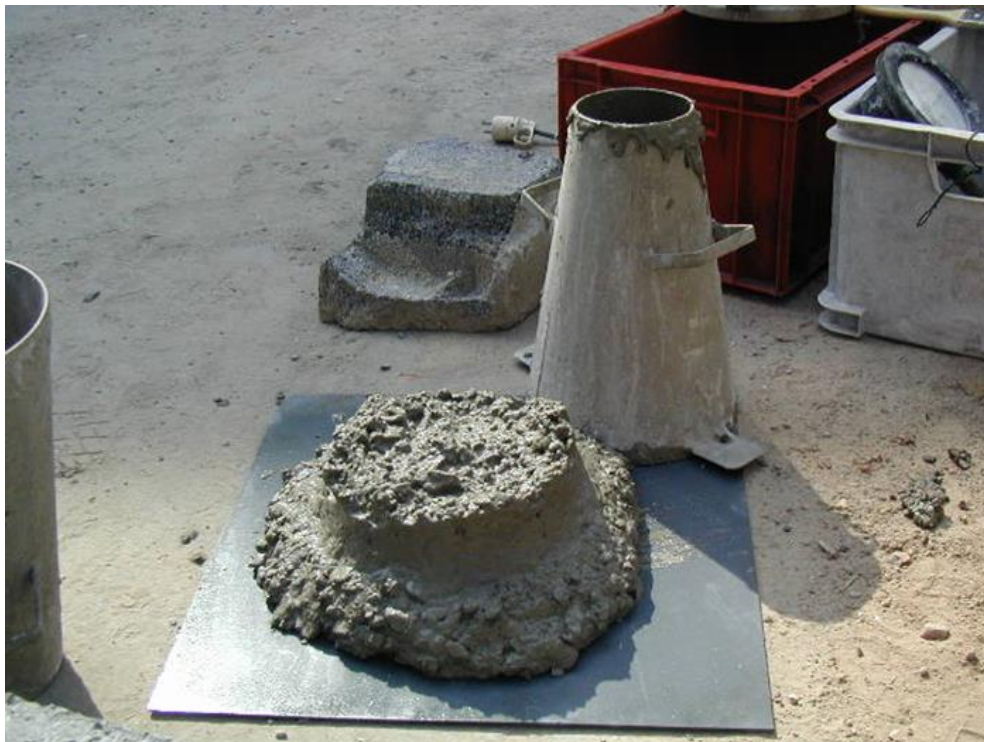
Figure 1 - Essai d'affaissement (Slump)
