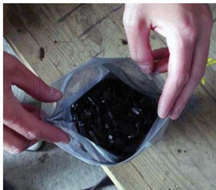
**Verschmutztes Holz, das durch eine Thermolyse Behandlung in saubere Holzkohle umgeformt wurde.**
