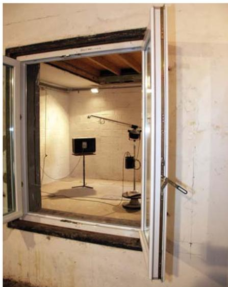
**Abb. 1** Es gibt jetzt sich öffnende Fensterrahmen mit einem Lautabschwächungsindex um die 45 dB.
