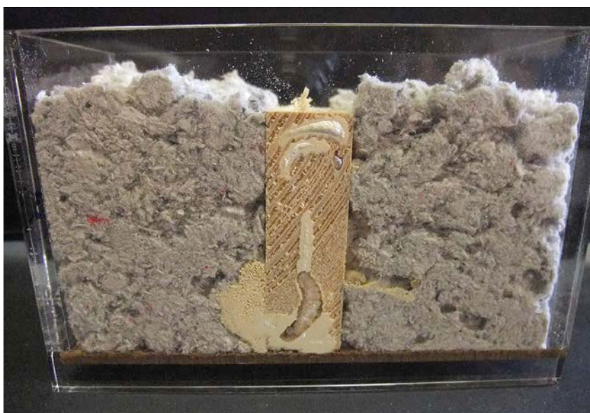
1 | Doos met cellulose-isolatie '0-6', een houten plankje en larven van de huisboktor.
