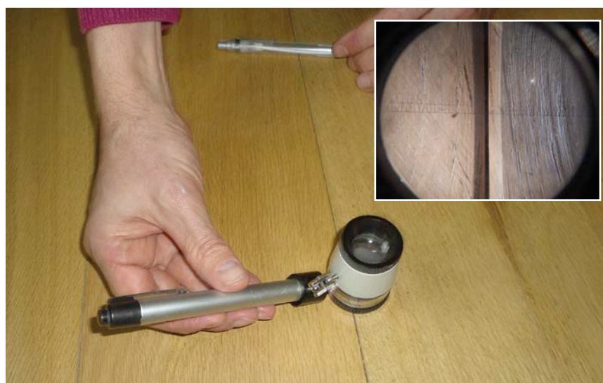
Vérification de la largeur des joints (à gauche) et du cintrage des lattes à la réception (à droite).
