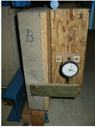
Figure 7 Dispositif d'essai de cisaillement sur échantillon.
