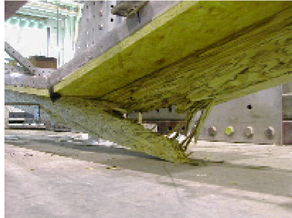
Afb. 11 Breuk ter hoogte van de houten balk.
