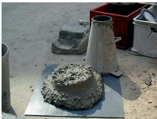
Afb. 1 Meting met de zetmaat ( slump ).
