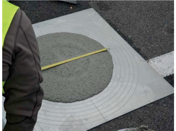
Afb. 4 Meting van de vloeimaat ( slump flow ).
