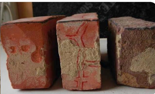
**3** Test de résistance au gel de briques de récupération.
