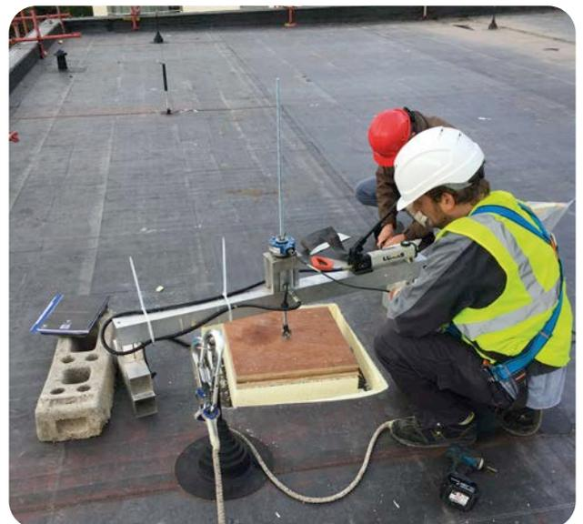
équipé d'une cellule de mesure de force (voir figure 1 à la page précédente)
