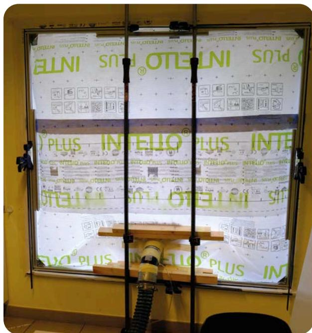
1 Mesure *in situ* de l'étanchéité à l'air d'une fenêtre.
