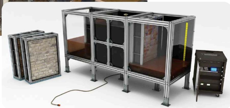
l'eau commence à s'infiltrer à travers le mur au cours de ce processus. Le niveau de l'eau est maintenu à un mètre tout au long de l'essai. Après une phase de transition, le débit de fuite évolue vers une valeur constante.
