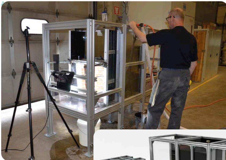
**5** Dispositif d'essai permettant de mesurer l'étanchéité de deux modèles de murs. La partie centrale est remplie (en continu) jusqu'à ce que l'eau atteigne la hauteur de 1 m. Le débit de fuite est contrôlé simultanément.
