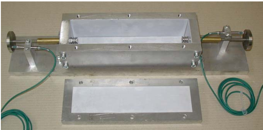
Fig. 6 Dispositif de mesure linéique du retrait endogène au jeune âge.
