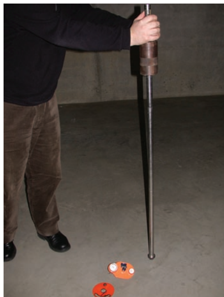
Fig. 3 Réalisation d'un essai à l'aide du screed tester (ci-dessus et à droite).
