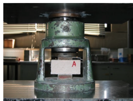
Fig. 1 Essais en compression et en traction par flexion sur des éprouvettes de 40 x 40 x 160 mm 3 .
