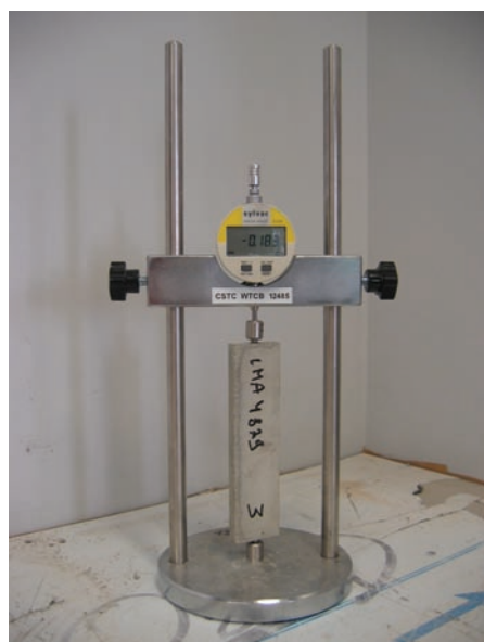
Fig. 2 Mesure du retrait libre sur une éprouvette selon la norme NBN EN 12808-4.
