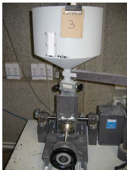
Fig. 3 Appareil 'Capon' pour la détermination de la résistance à l'abrasion selon la norme NBN EN 12808-2.
