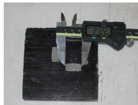
Fig. 4 Mesure de l'empreinte abrasée sur une éprouvette selon la norme NBN EN 12808-2.
