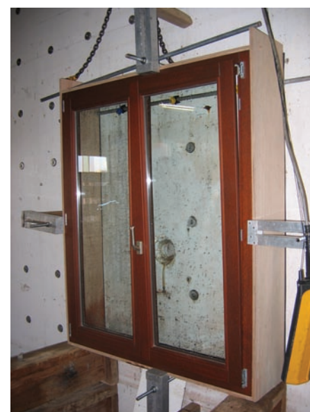
Banc d'essai du CSTC destiné à mesurer les performances d'étanchéité à l'eau et à l'air des menuiseries.
