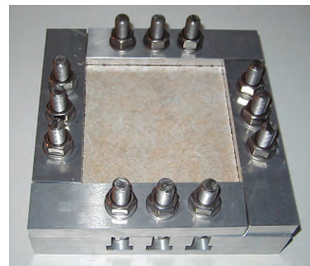
Fig. 2 Cadre métallique dimensionné pour reproduire le blocage.
