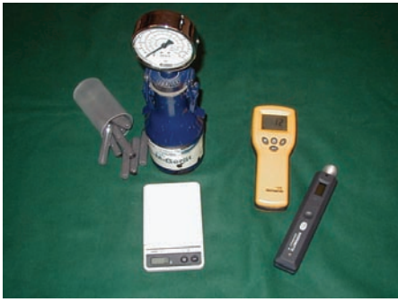
Fig. 6 Exemples d'instruments de diagnostic de l'humidité des matériaux.
