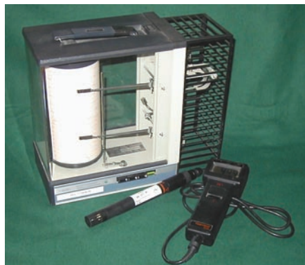
Fig. 4 Exemple d'un thermo-hygromètre.
