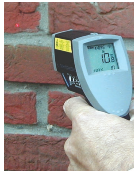
Fig. 5 Exemple de thermomètre 'infrarouge'.
