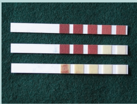
Fig. 13 Constatations sur bandelettes 'sulfates'.
