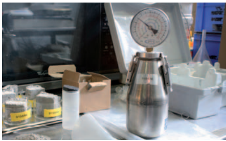
Fig. 9 Exemple de bombe à carbure.
