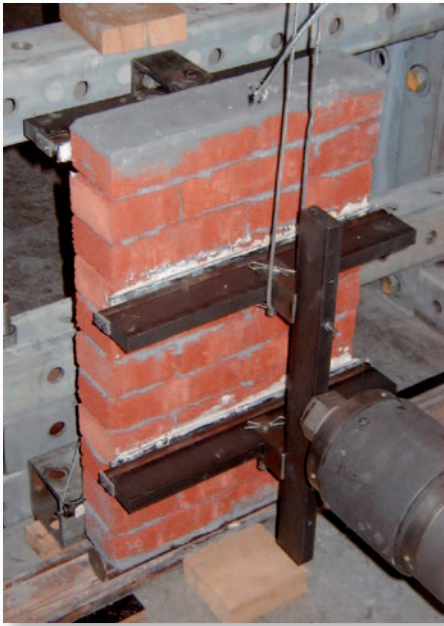
Fig. 5 Détermination de la résistance à la flexion parallèle ( f_{xk1} ) selon la norme NBN EN 1052-2 [7].
