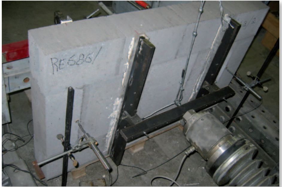
Fig. 6 Détermination de la résistance à la flexion perpendiculaire ( f_{xk2} ) selon la norme NBN EN 1052-2 [7].
