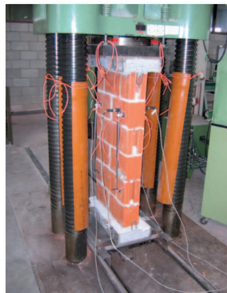
Fig. 3 Essai de compression sur muret selon la norme NBN EN 1052-1 [6] (avec détermination du module d'élasticité sécant 'E').
