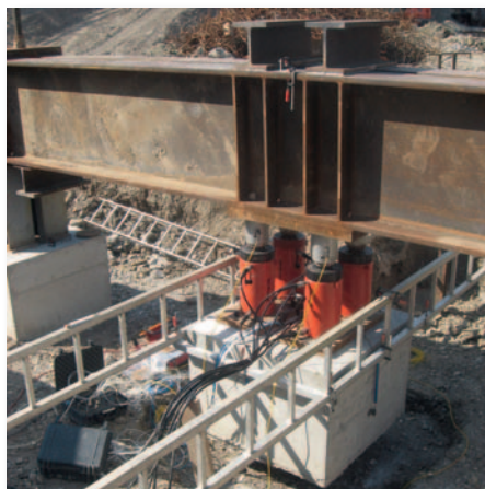
Schéma de principe de la méthode impulsionnelle et illustration de l'essai de chargement statique
