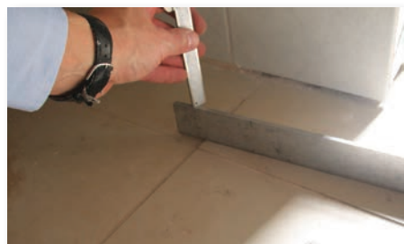
Fig. 1 Mesurage du désaffleurement réel entre deux carreaux adjacents
