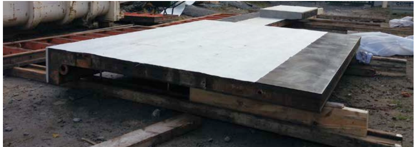
1 | Panneau de coffrage partiellement muni d'une NCPC
