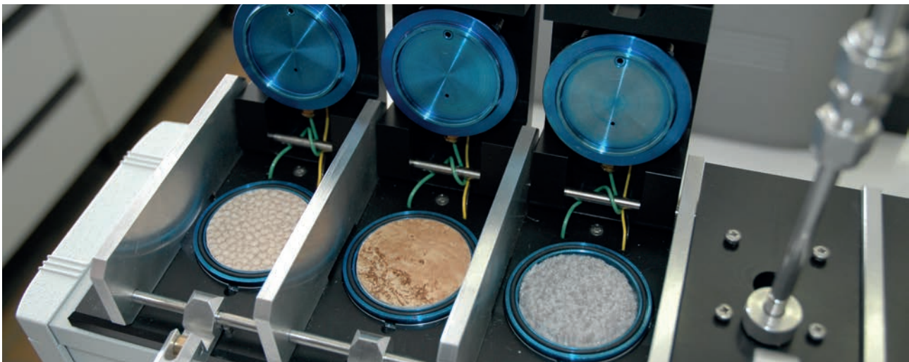
Mesures d'émission sur différents types de revêtements de sol dans le cadre du projet TAP HEMICPD
