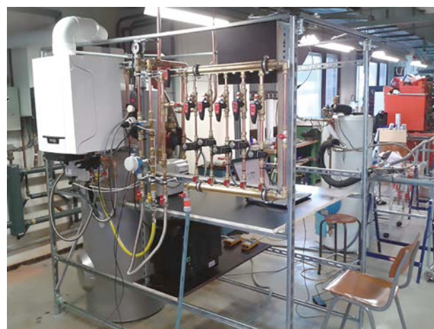
1 | Dispositif d'essai permettant de mesurer le rendement de production d'ECS selon le principe de la directive Ecoconception
