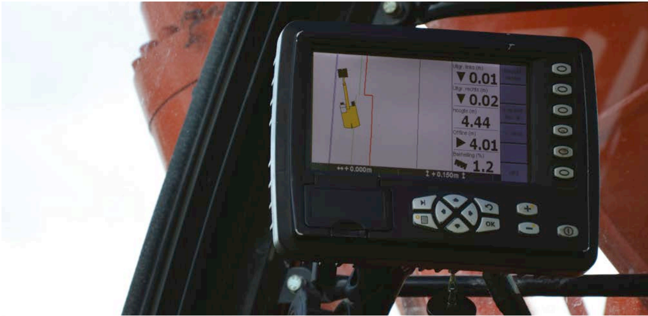
2 | Indication de la position du godet de la pelleuse
