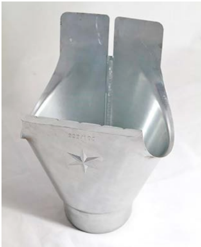
1 | Naissance universelle munie d'une ouverture d'évacuation de 100 mm de diamètre pour une gouttière demi-ronde d'une largeur développée de 333 mm
