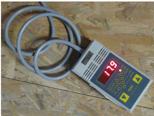
2 | Mesure de la puissance électrique absorbée à l'aide d'un puissance-mètre.
